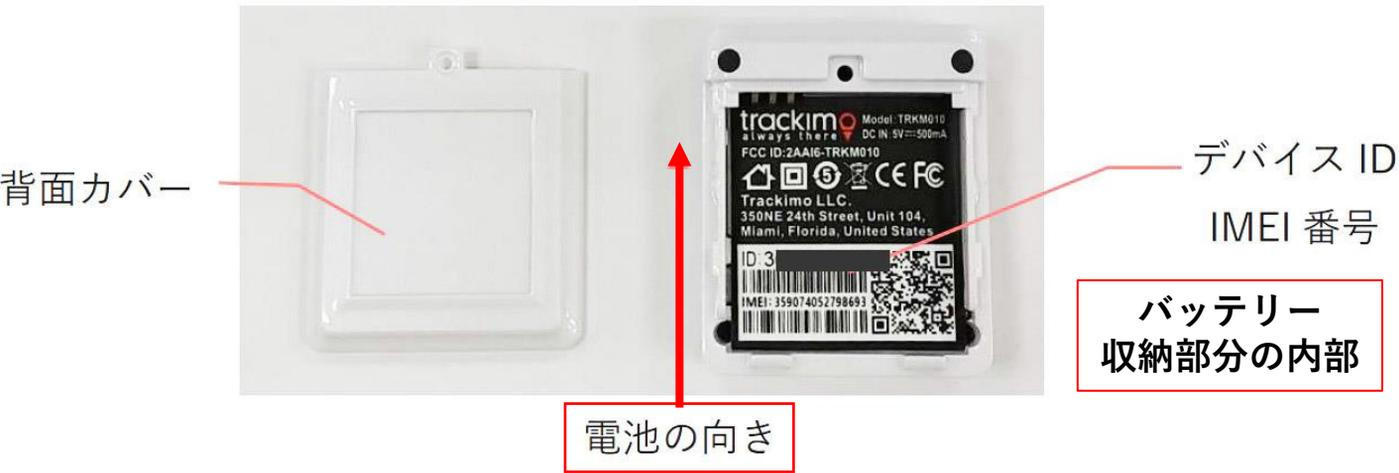
デバイス本体の背面カバーの中央を軽く押してスライドさせ、背面カバーを外してください。付属品の電池を正しい方向に取り付け、背面カバーを元に戻します。
